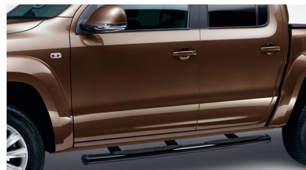
Le soglie tubolari robuste e resistenti, con un diametro di 76 mm, costituiscono un accento di forte personalità e un pratico ausilio di accesso grazie alla pedana integrata. I tubi sono montati con tre supporti sui punti di fissaggio presenti di serie senza forature aggiuntive e sopportano fino a 200 kg di peso.
